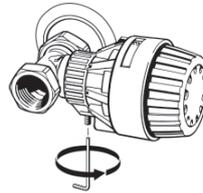
Die Schelle lässt sich nach Wahl in vier Positionen drehen. Die Schraube mit einem 2-mm-Sechskantschlüssel anziehen.
