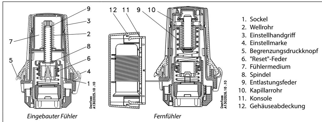
Die Fühler arbeiten mit einem flüssigkeitsgefüllten Wellrohrelement, das von der Raumtemperatur direkt gesteuert wird. Wenn die Raumtemperatur sinkt, zieht sich das Wellrohr im thermostatischen Element zusammen und öffnet das Ventil. Dadurch wird die Wärmezufuhr
