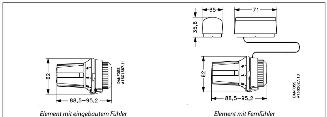
Element mit eingebautem Fühler
